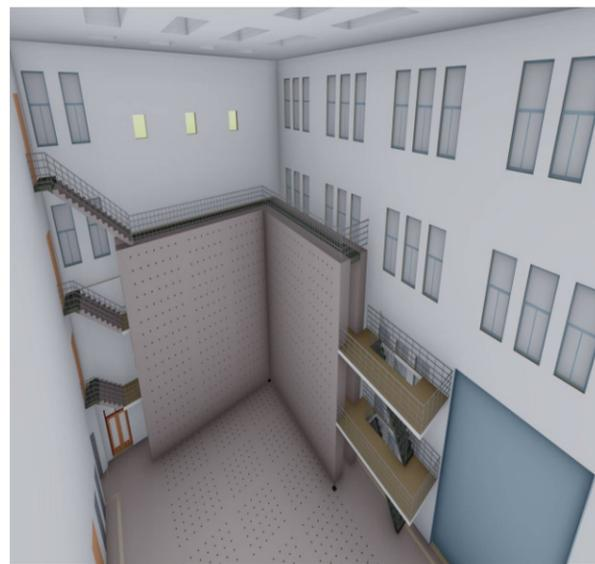
安徽省建筑科学研究设计院抗震实验室项目反力墙加载孔装置制作与施工
